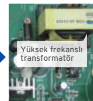
Bağılı güç kaynağı (Yüksek frekanslı Inverter + Anahtar devresi)
